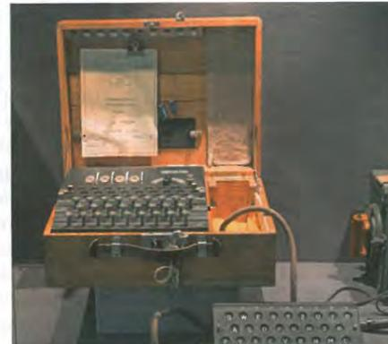
**Enigma K (1942-1947)** Inventée en Allemagne, la machine à chiffrement électromagnétique à rotors Enigma est acquise par la Suisse au début de la guerre. La Confédération la modifie et l'utilise pour ses communications militaires et diplomatiques. Or le code a été cassé par les alliés durant la guerre et les messages helvétiques n'auront plus de secrets pour les Américains au moment des négociations après-guerre sur les avoirs allemands placés en Suisse.
